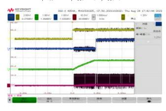
EN start , V<sub>IN</sub>=12V ,V<sub>OUT</sub>=1.0V, I<sub>OUT</sub>=3A
