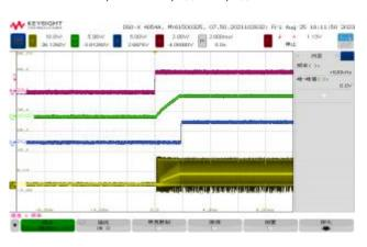
EN start, V<sub>IN</sub>=12V, V<sub>OUT</sub>=5V, I<sub>OUT</sub>=3A
